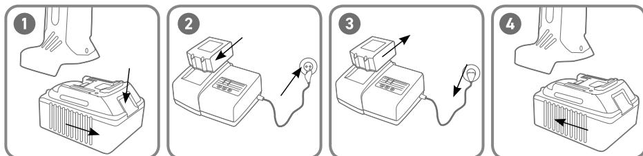
Для снятия аккумулятора, нажмите на фиксатор и извлеките его из корпуса инструмента.
