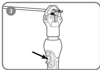
Нажмите и удерживайте кнопку «ПУСК» до срабатывания механизма автоматического сброса давления.
