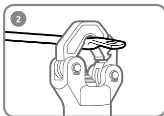
Установите опрессовываемое изделие в рабочую зону инструмента. При необходимости откройте откидную часть рабочей головы.
