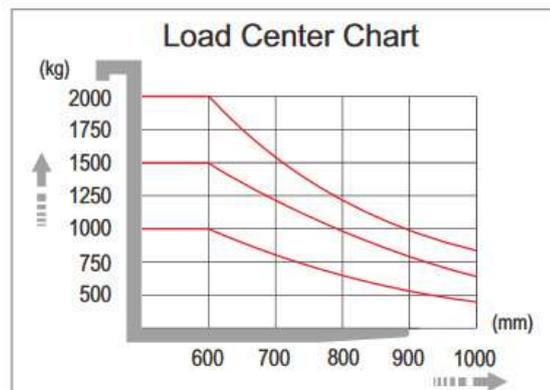
Рис.2 - График грузоподъемности
