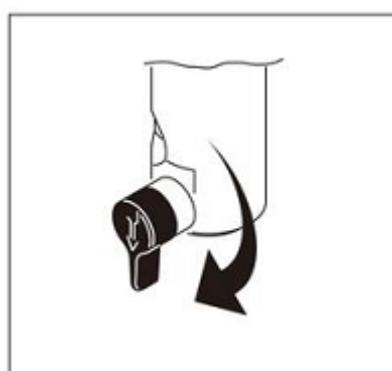
9. Поверните клапан фильтра вниз и дайте промывочной жидкости поциркулировать 1-2 минуты, чтобы очистить сливную трубку.
