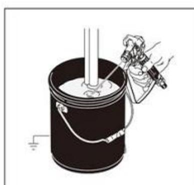
8. Перенесите распылитель в ведро с промывочной жидкостью, прижмите его к стенке ведра и нажмите на спусковой механизм, чтобы тщательно промыть систему. Отпустите спусковой механизм и активируйте предохранитель спускового механизма.
