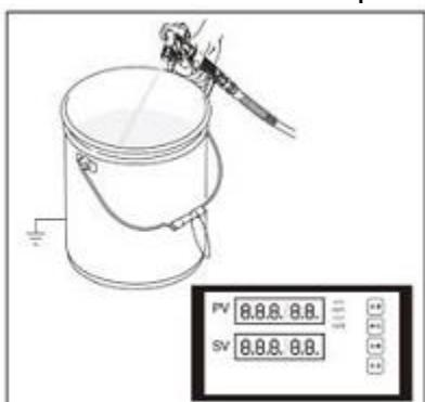
7. Прижмите краскораспылитель к стенке ведра. Нажмите на предохранительный штифт. Нажмите на спусковой механизм распылителя и увеличивайте давление, пока из распылителя не пойдет жидкость.
