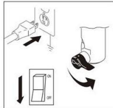
6. Вставьте шнур питания в розетку. Включите питание на переключателе. Поверните клапан фильтра в горизонтальное положение
