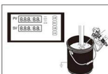
2. Установите давление на минимальное значение. Нажмите на спусковой механизм распылителя и удерживайте, чтобы сбросить давление
