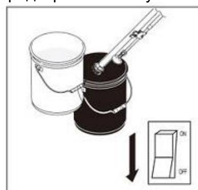
10. Поднимите всасывающую трубку выше уровня промывочной жидкости и дайте распылителю поработать 15-30 секунд, чтобы слить жидкость. Выключите питание.
