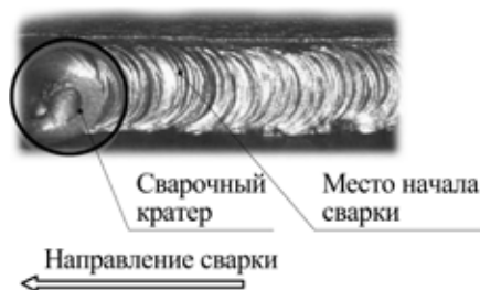
Рис. 9.4. Начало сварки при смене электрода.
