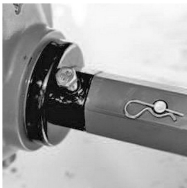
Шаг 4. Поочередно установить ступицы колес с колесами в сборе на шестиугольные полуоси выходного вала. Совместить монтажные отверстия на колесной ступице и шестиугольном валу. Зафиксировать колесную ступицу на шестиугольном валу соединительным пальцем. Зафиксировать соединительный палец пружинным шплинтом.
