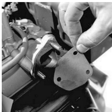
Шаг 8. Убрать защитную прокладку с воздушного впускного коллектора двигателя
