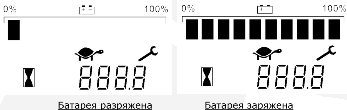
Рис.13: Индикатор заряда АКБ
